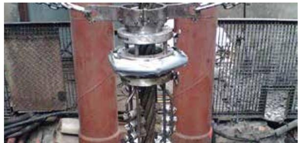
Para la postimpregnación de cables utilizamos solo los lubricantes específicos. En su amplia gama de productos existen agentes protectores para todo tipo de cables, incluidos los cables tractores que trabajan arrastrados por la polea tractora en las instalaciones de montaña o mineras, cables guía o carril o cables que trabajan sumergidos en el agua.
